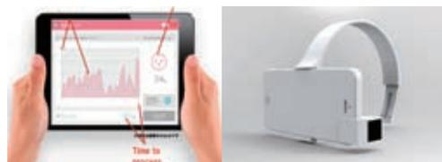
図2 左：ストレス度、興味度、関心度、快適度、眠気、集中度、好き度を検出できる装置 右：モバイル型脳波計測装置
